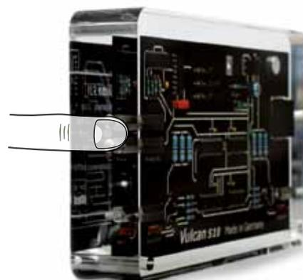
Дотроньтесь до обоих металлических выступов для программирования
