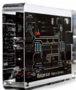
Акриловая заливка обеспечивает очень долгий срок эксплуатации. Прочный изоляционный материал, акрил, обеспечивает прибору Vulcan защиту от электричества при возможном сгорании блока питания, изолированного от внутренних компонентов прибора.
